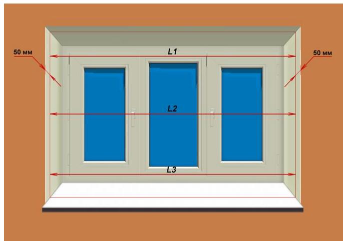
**Вертикальный размер** измеряется на уровне 50 мм от края откоса в трех точках. **Вертикальный размер не должен превышать** ширины рулона ткани минус 10 см. ширину рулона указана на образцах. **При использовании цепочного управления** необходимо определить расположение управления и его длину. Длина управления должна быть не меньше 2/3 высоты изделия в закрытом состоянии.
